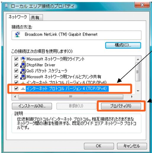
1.「この接続は次の項目を使用します(O)」の項目にある「インターネット プロトコル バージョン4(TCP/IPv4)」にチェックを入れ選択する。
